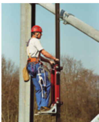
11. ábra: „HighStep” rendszer motoros félautomata berendezéssel
