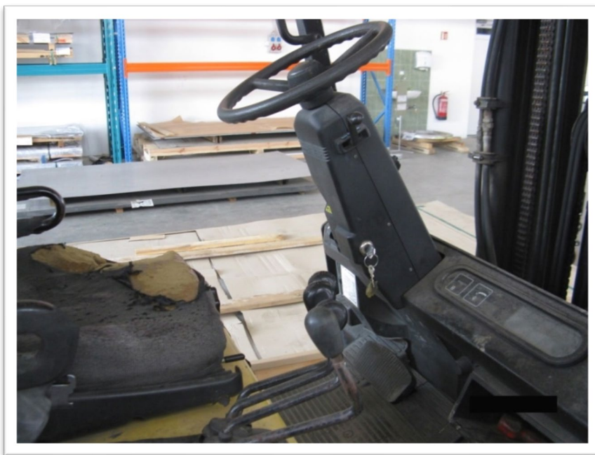
Az üzememen kívüli targonca indítószerkezetében hagyott indítókulcs
