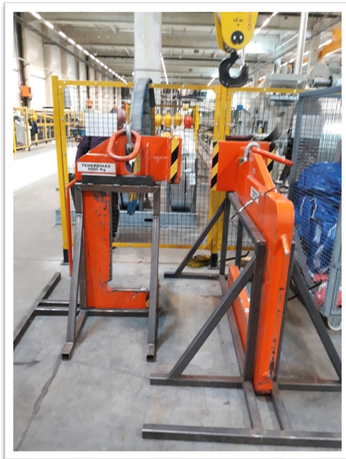
Acéltekercsek emelésére alkalmas teherfelvevő szabályos tárolása
